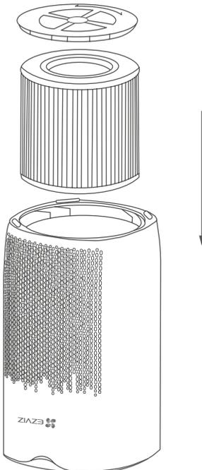
2. Une fois le filtre placé dans la machine, alignez la forme triangulaire du couvercle inférieur avec le triangle de la machine et tournez-le dans le sens des aiguilles d'une montre pour le serrer.
